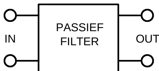
△ Fig.4.1 Vierpool voorstelling van een passief filter. Tekening: W. Van Wichelen
