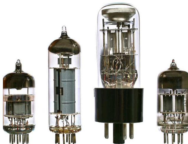
△ Fig.5.1 | Een set hedendaagse elektronenbuizen. Bron: World Wide Web
