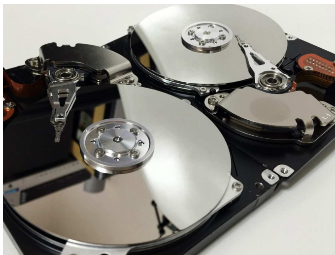
△ Fig.1.6 | Opslag van digitale informatie op harde schijven gebeurt door magnetisatie en wordt nog veel toegepast. Bron: https://pxhere.com
