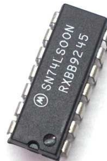
△ Fig.2.21 | Een low power TTL NAND-poort in vol ornaat met bijhorende pinout. Het 'bolletje' geeft pin 1 aan. Bron: https://components101.com
