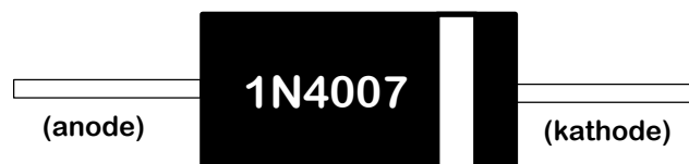
△ Fig.2.1 Verschillende voorstellingen van de siliciumdiode: als PN-junctie (boven), als schemasymbool (midden) en in zijn praktische gedaante (onder). Bron: W. Van Wichelen
