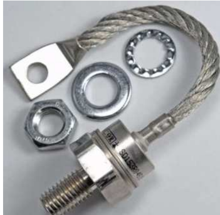
△ Fig.2.3 Een voorbeeld van behuizingen van diodes die zeer grote vermogens kunnen doorschakelen. Door deze typische vorm is het mogelijk de component te bevestigen aan een koelprofiel om een goede warmte-afvoer mogelijk te maken. Bron: World Wide Web
