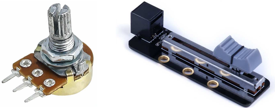
△ Fig.2.6 | Draai potentiometer en schuifpotentiometer. Bron: https://ardubotics.eu , https://elektronicavoorjou.nl
