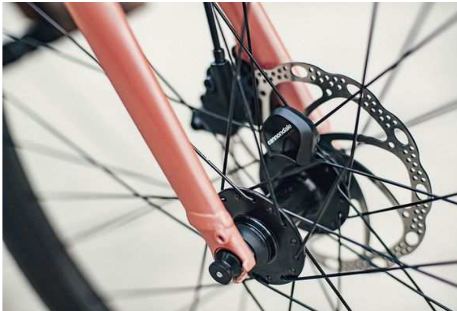
△ Fig.2.21 | Reedcontact als wielsensor. Bron: https://www.want.nl/cannondale-wielsensor-fiets
